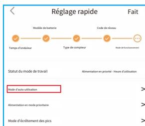
**Mode d'auto-utilisation** Stocke l'excédent d'énergie photovoltaïque dans la batterie. Si la batterie est chargée ou déchargée, l'excédent d'énergie photovoltaïque est exporté (revendu) au fournisseur d'énergie. Si le système est configuré pour ne pas exporter d'énergie, l'onduleur réduit la puissance photovoltaïque (réduction de la puissance de sortie de l'onduleur).
