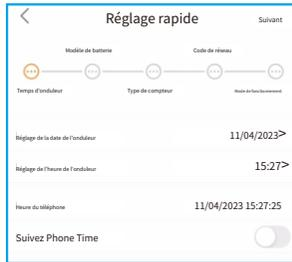
B. Modèle de batterie : Sélectionnez maintenant le modèle de batterie connecté à l'onduleur. Ce choix doit être basé sur le modèle de batterie réellement connecté à l'onduleur. Si aucune batterie n'est connectée pour le moment, sélectionnez « Aucune batterie » pour éviter les codes d'alarme potentiels.
